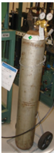
Figura 3.2 - Exemplo de cilindro CO 2 para carregar o sistema frigorífico.
