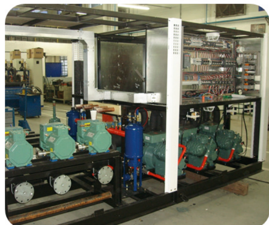
Figura A3.11 - Detalhe da montagem dos compressores de CO 2 . (Fonte: Plotter-Racks)
