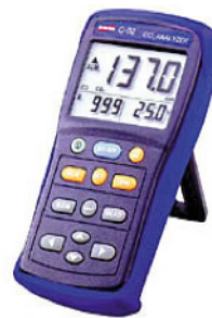
Figura 5.17 - Exemplo de sensor portátil para medir a concentração de CO 2 .
